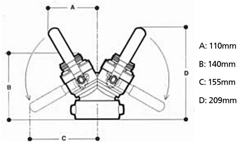
Dimensões aproximadas, em milímetros e sem os adaptadores tipo engate rápido.
